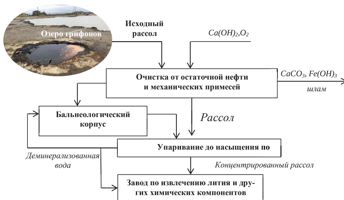
Рис. 2. Схема комплексного использования литийсодержащего рассола Берикейского месторождения Республики Дагестан
